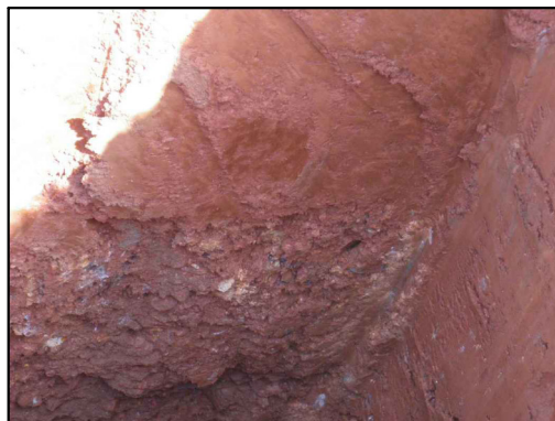
Sezione di scavo di P5: particolare del contatto tra il livello fine ed i depositi ghiaioso-ciottolosi sottostanti
